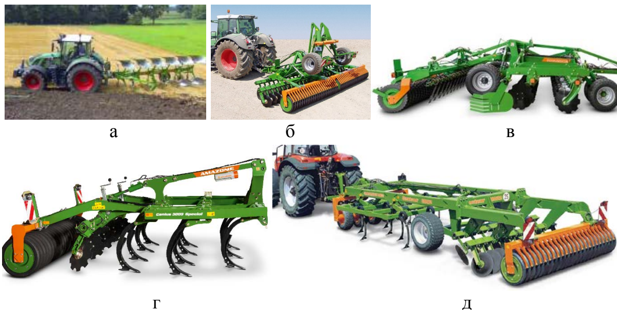
Рис. 2. Почвообрабатывающие орудия компании «AMAZONE-Werke»: а) навесной оборотный плуг Saugon; б) дисковая борона Catros; в) тяжелая дисковая борона Certos; г) культиватор Senius; д) культиватор Centaur.
